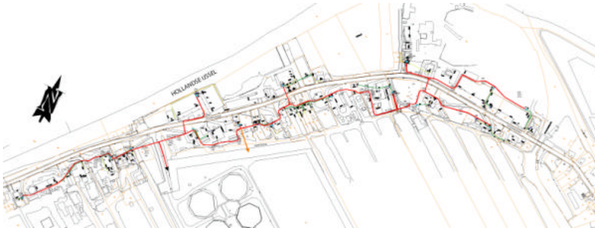
Afbeelding 2: het rioleringstracé (in rood).
