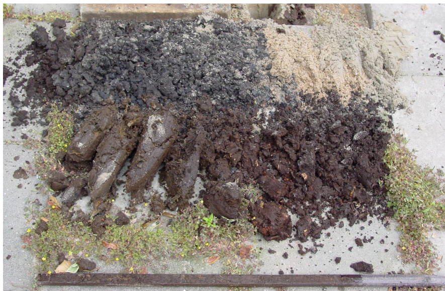
Afbeelding 16: opgeboord materiaal boring 001. Rechtsboven de top van de boring (ca. 40 cm ophoogzand), links naast circa 50 cm kleiige bouwvoor, en daaronder veen.
